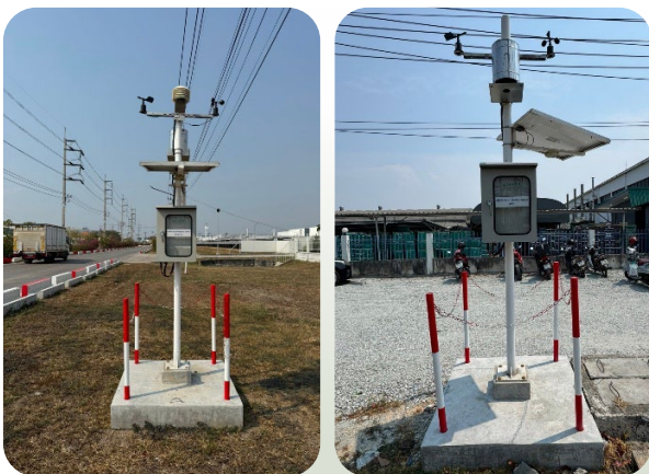
สถานีอุตุนิยมวิทยาแบบออนไลน์ (smart weather station) ในพื้นที่นิคมอุตสาหกรรมอมตะซิตี้ ชลบุรี
